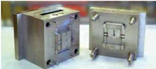
Toolox® wurde ursprünglich als Kunststoff-Formenstahl entwickelt, bald schon erwies dieser Werkstoff sich als außerordentlich geeignet für eine Vielzahl von weiteren Anwendungen.
